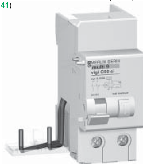
Fig. 41: Ejemplo de DDR de tipo A adaptable a un disyuntor BT (Bloque Vigi C60-300 mA – Merlin Gerin).
